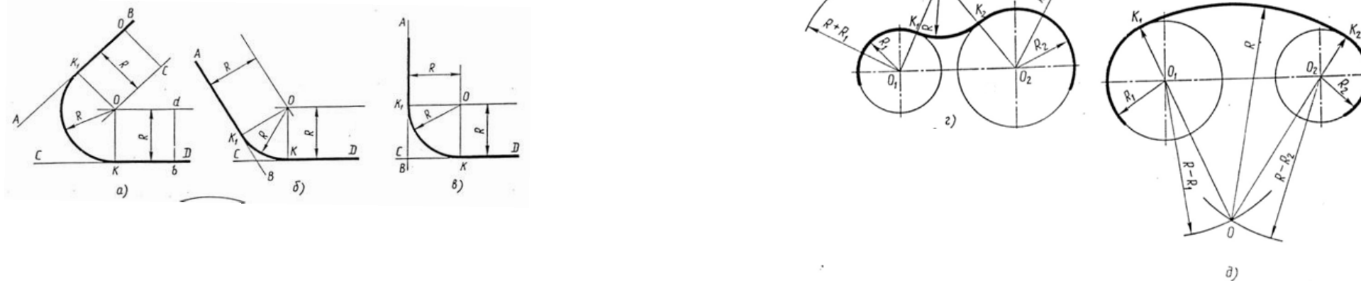
Рис. 1 – Примеры построения сопряжений
