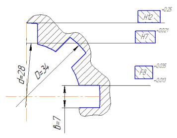
Рисунок 10 - Схема расположения полей допусков.
