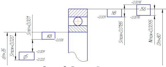
Рисунок 7 - Схема полей допусков.
