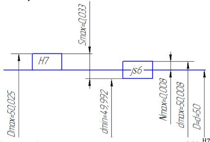
Рисунок 1- Схема полей допусков соединения  $\emptyset 50 \frac{H7}{is6}$
