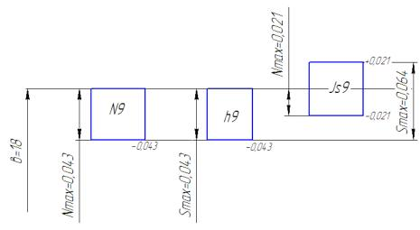
Рисунок 9 – Схема расположения полей допусков.
