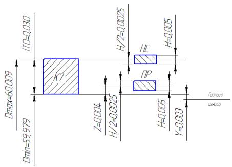
Рисунок 5 - Схема расположения полей допусков.
